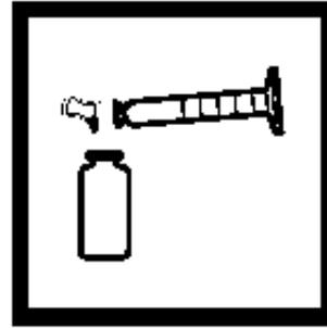
11. 往另一个比色瓶中装入量筒中余下的稀释后的滤液至10mL刻度线，并加入一包 ChromaVer 3铬试剂粉包，混合。此为待测试样。
