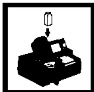
14. 将待测样品放入比色瓶槽，关上遮光盖。屏幕将显示铅的含量，单位为  $\mu\text{g/L}$ 。
