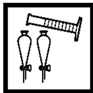
13. 分别加入 30 mL甲苯到两个漏斗中，盖好盖子，混合，然后打开活塞通气，再关上活塞。重复两次。
