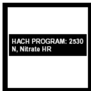
2. 屏幕显示: HACH PROGRAM: 2530 N, Nitrate HR, 波长自动调节为500nm。
