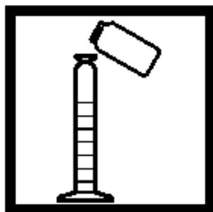
2. 从下面的表1中选择所需的样品体积。量取所需的样品体积到50mL量筒中。加去离子水至50mL刻度线。混合。
