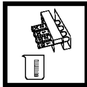
3. 10分钟后将TPH抗体管的内容物倒入废物缸。
