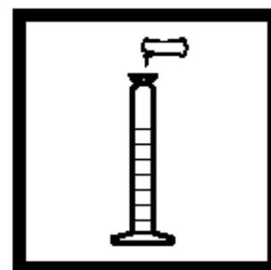
4. 各加入一包银2试剂粉包到两个混合量筒中，混合，使粉末完全湿润。
