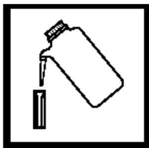
1. 往1cm的管中加入1.5 mL去离子水（空白试样）。用纸擦去管外壁的污物和指纹。
