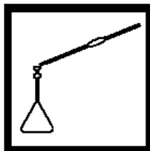
3. 稀释铂的电解质溶液(样品): 量取1.00mL电解质溶液到1000mL的带刻度的瓶子中, 加入去离子水到1000mL刻度。盖好盖子, 倒转至少10次, 混合。
