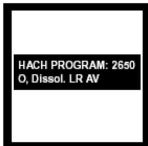
2. 屏幕显示: HACH PROGRAM: 2650 O, Dissol. LR AV, 波长自动调节为 610nm。
