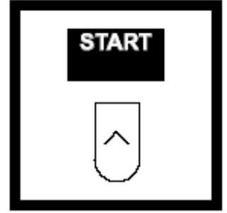
8. 按 START ，从780nm开始，仪器将以5nm的间隔读出百分透光值(%T)，直到380nm。完成以后，仪器将显示样品的加纳尔色度值。
