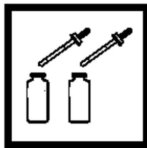
11. 用1-mL 校准过的点滴器，加入1.0mL的N,N'-Dimethyldithiooxamide指示剂溶液到每个管中，混合。
