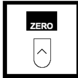
7. 按 ZERO 归零，屏幕将出现“0.0mg/L Cl<sub>2</sub>”。
