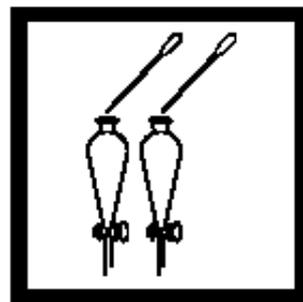
12. 用校准过的1.0mL塑料点滴器分别加入 2.0 mL的12 N 氢氧化钾标准溶液到两个漏斗中，盖好盖子，摇晃混合。
