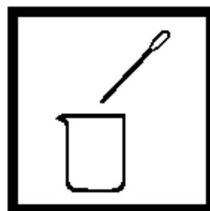
4. 用塑料的1-mL点滴器加入 1.0 mL pPb-1 酸防腐剂溶液到样品中，混合。
