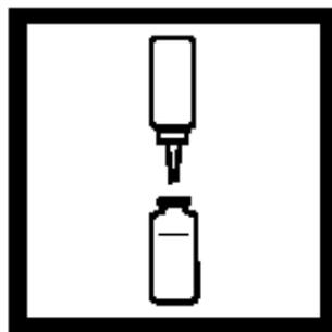
6. 分别加入15滴碱性氰化物试剂溶液到每个比色瓶中，混合。
