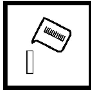
3. 往1cm 的比色皿中装入样品,待测。注:其他规格的比色皿可用于颜色很浅的样品。放入相应的比色瓶槽,并按OPTIONS,然后PATH。输入管路径长,按ENTER。屏幕将显示路径长。
