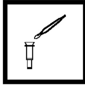
15. 用镊子取走每个CRC上的滤器，将每个滤器放入相应的三价锰COD瓶。
