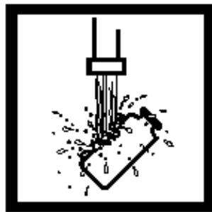
10. 当计时器鸣叫时，用流动的自来水将冷却溶液到25 °C（直到比色瓶冷却到该温度）。
