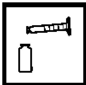
6. 倒出25 mL混合液到25mL的比色瓶中（待测试样）。
