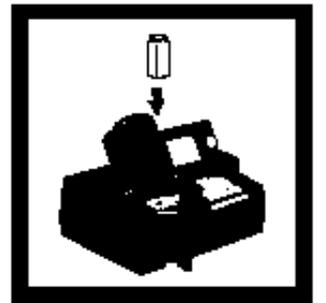
16. 将待测试样放入比色瓶槽，关上遮光盖。结果显示总凯氏氮的含量，单位为mg/L。
