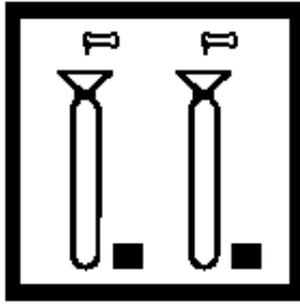
9. 用漏斗分别加入一包氨水杨酸试剂粉包（用于5mL样品）到每个瓶中。
