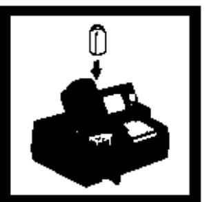
10. 将步骤7的待测样品放入比色瓶槽。关上遮光盖。屏幕显示三价铬的含量，单位为g/L。
