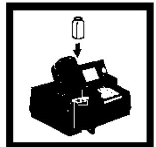
8. 将待测样品放入比色瓶槽,关上遮光盖,屏幕显示 $\text{PO}_4^{3-}$ 的含量,单位为mg/L。
