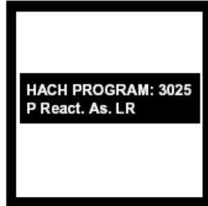
2. 屏幕显示: HACH PROGRAM: 3025 P React. As. LR, 波长自动调节为890nm。
