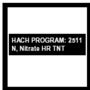
2. 屏幕显示: HACH PROGRAM: 2511 N, Nitrate HR TNT, 波长自动调节为410 nm。
