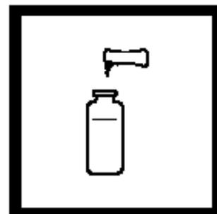
4. 加入一包 DPD 总氯粉包到比色瓶（待测试样），混合。
