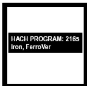
2. 屏幕显示：HACH PROGRAM: 2165 Iron, FerroVer, 波长自动调节为510 nm。
