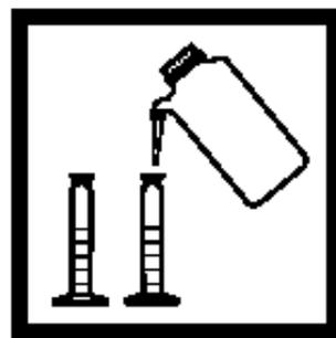
3. 往两个25-mL混合量筒中分别装入去离子水到20mL刻度。
