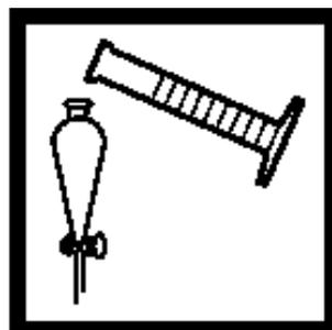
3. 用500ml的量筒量取300mL样品，倒入500mL分液漏斗中。
