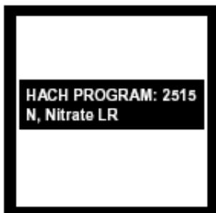
2. 屏幕显示：HACH PROGRAM: 2515 N, Nitrate LR，波长自动调节为507nm。
