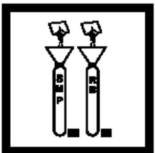
6. 用漏斗各加入一包 TOC Persulfate 粉包到酸消化瓶（无色液体）。
