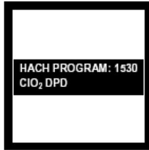
2. 屏幕显示: HACH PROGRAM: 1530 ClO<sub>2</sub> DPD, 波长自动调节为530 nm。
