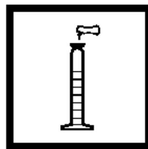
4. 加入一包FerroMo铁试剂1粉包到量筒中，盖好盖子，倒转多次使试剂溶解。此为待测样品。
