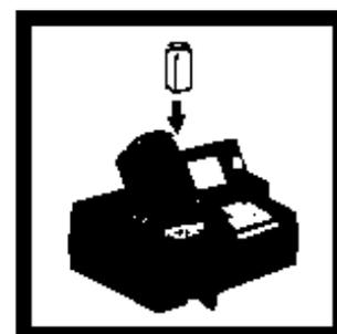
12、将试样瓶放入 DR/4000，盖上遮光盖，即可测得 mg/l SiO<sub>2</sub> 浓度。
