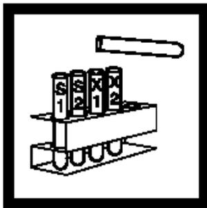
1. 将酶联管内容物倒入相应的TPH抗体管中，混合。
