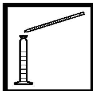
3. 从表1中选择合适的样品大小, 移取所需体积到50mL混合量筒中, 如有需要, 用去离子水稀释样品至50mL, 并充分混合。
