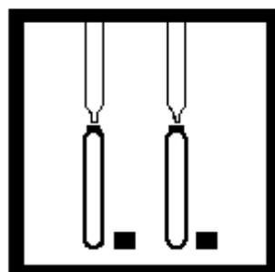
4. 移取1 mL样品到一个瓶中(样品), 移取1mL去离子水到另一瓶中(空白试样)。盖好瓶盖, 摇晃30秒混合。
