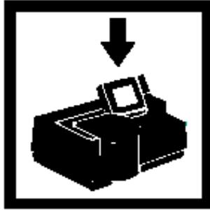
10. 计时器鸣叫后，立即读出屏幕上显示的联氨的含量，单位 $\mu\text{g/L}$ 。
