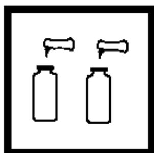
7. 当计时器鸣叫时,分别加入一包 Ammonia Cyanurate 试剂粉包到每个瓶中,盖好盖子,摇晃使粉末溶解。
