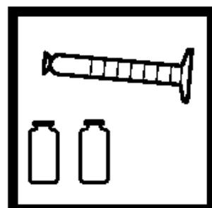
4. 往一个1英寸比色瓶中装入步骤3中的稀释样品至10mL刻度 (空白试样)。往另一个1英寸比色瓶中装入步骤3中的稀释样品至25mL刻度。
