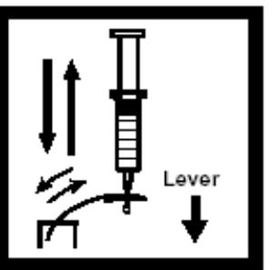
19. 阀门处于吸气档，吸入25cc去离子水清洗注射器和针筒，弃去水。
