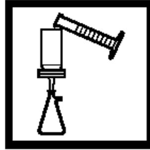
3. 用大约50mL的去离子水冲洗过滤器，弃去冲洗液。
