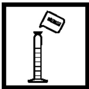
7. 往量筒中装入步骤3的脱氯的水至50mL刻度线，盖好盖子，混合。余下的水留到步骤9。
