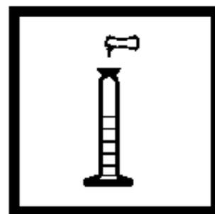
4. 将一包 ZincoVer 5 试剂药包加入量筒中，塞好塞子。反转多次使粉末完全溶解。注意！该步骤中的试剂含有氰化物，取出试剂或吸入气体都是有毒的。不能加到酸性样品中（ $\text{pH} < 4$ ）。
