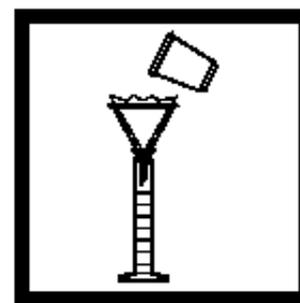
7. 往50mL量筒中放入漏斗, 并放上一张已折叠好的滤纸, 过滤土壤/提取剂混合液, 收集滤液。
