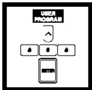
1. 该程序需要用户对每个电解质试样输入校准。输入最初的校准之后，按USER PROGRAM，选择自身催化铜的程序编号，按ENTER。
