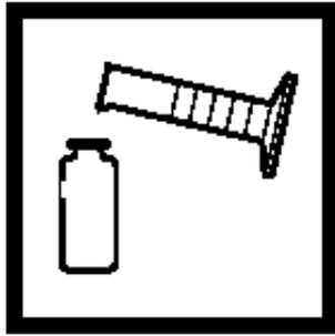
17. 往一个干的比色瓶中装入还没有反应的砷吸收溶液（空白溶液）。盖上盖子。将它放入比色瓶槽。
