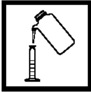
9. 稀释量筒中的滤液到25mL刻度线，盖好盖子，混合。
