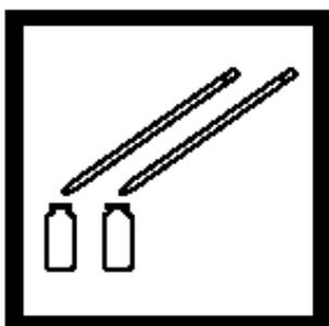
6. 加入 1.5mL ethylene glycol到每个比色瓶中。旋转混合。
