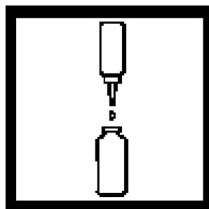
6. 将一滴ECR Masking试剂溶液滴入一个干净的比色瓶中，以此作为空白。
