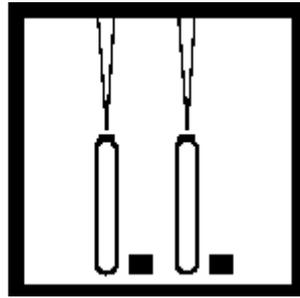
3、取 2 ml 水样加入其中一管，为待测组；另取 2 ml 无氨水（蒸馏水、纯水）加入另一管，做为空白组旋紧盖子后，充分摇晃 30 秒，放入 COD 加热器内，加热 30 分钟。
