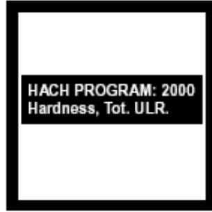
2. 屏幕显示: HACH PROGRAM : 2000 Hardness, Tot. ULR, 波长自动调节为669nm。
