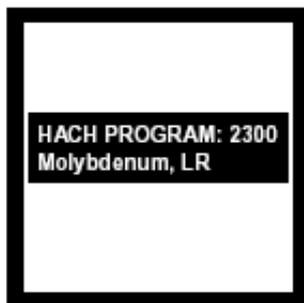
2. 屏幕显示：HACH PROGRAM : 2300 Molybdenum, LR，波长自动调节为 610 nm。
