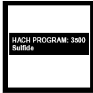
2. 屏幕显示: HACH PROGRAM : 3500 Sulfide, 波长自动调节为665 nm. ,
