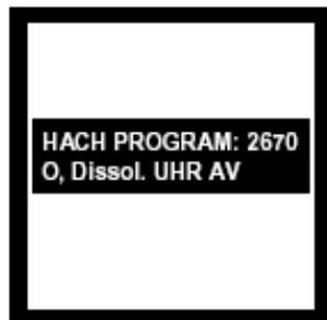
2. 屏幕显示: HACH PROGRAM: 2670 O, Dissol. UHR AV, 波长自动调节为680nm。
