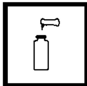
6. 加入一包FerroMo铁试剂2粉包到比色瓶，摇晃使试剂溶解。此为进一步的样品。
