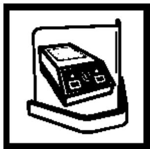
1、开启 COD 反应炉，加热至 103-106℃，将塑料隔板置于反应炉前。
