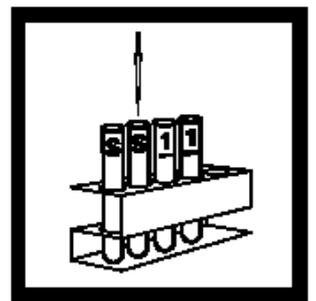
4. 用TenSette移液管和一新的吸头分别加入0.5mL去离子水到每个管中，混合。
