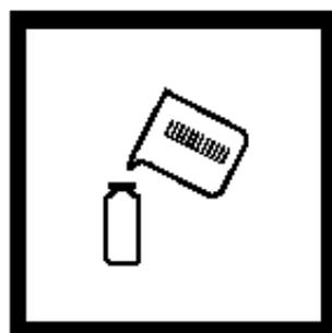
3. 往带玻璃塞的比色瓶中装入样品至10mL刻度线(待测样品)。
