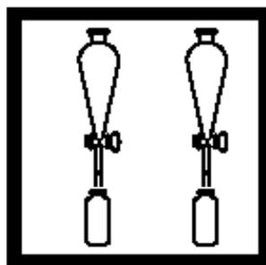
14. 分别将每个漏斗中的氯仿层分到相应的比色管中（一个为“空白试样”，一个样品对应一个比色管）。
