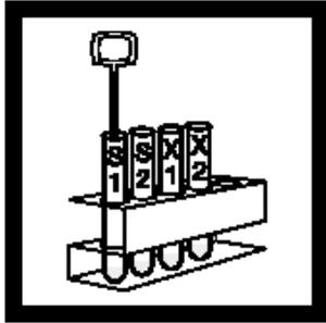
5. 用 WireTrol 移液管移取 0.05mLTPH 标准溶液加入到“标准1”和“标准2”的TPH酶联管中，充分混合。
