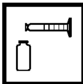
7. 从量筒中将溶液倒入一个25mL的比色管中(待测样品)。
