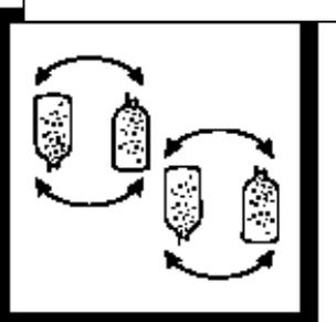
7. 迅速倒转安培瓶几次, 混合。用Kimwipe擦去液体和指纹。
