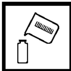
3. 往一个带玻璃塞子的比色瓶中装入样品至25mL刻度。(待测样品)。
