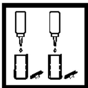
5.各加入10滴1M的EDTA 溶液到每个比色瓶中,分别盖好盖子并倒转两次使溶液混合。
