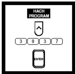
2. 在HACH PROGRAM下,选择acid hydrolyzable phosphorus程序编号3037,按ENTER。
