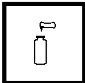
7. 加入一包10mL TPTZ铁试剂粉包到去离子水中，盖好盖子，摇晃30秒，取走盖子，此为空白试样。
