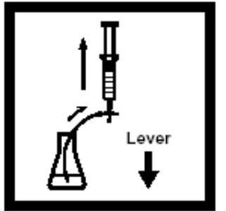
8. 将阀门转到吸气档（向下）。通过管道抽取5cc试剂空白到注射器中，吸入空气到30cc刻度线。
