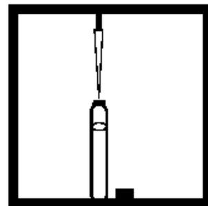
4. 用TenSette 移液管加入5mL样品到一个Total and Acid Hydrolyzable测试瓶,盖上盖子并混合。
