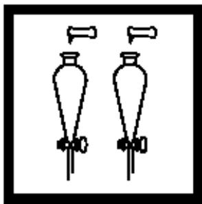
9. 分别加入一包苯酚2试剂粉包到每个分液漏斗中，盖好盖子，摇晃使粉末溶解。
