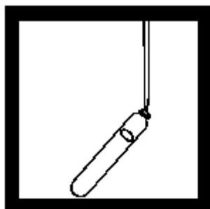
7、重复步骤 3~6，以去离子水取代试样，制备空白试样。
