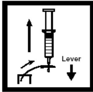
10. 通过管道将余下的试剂空白吸入注射器，然后吸入少量空气，超过 30cc 刻度线。
