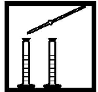
4. 各加入 1.0 mL 二氧化氯试剂1到每个量筒中，盖上盖子。倒转多次混合。
