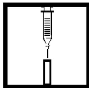
12. 用装有提取溶液的注射器加入 3 mL 溶液到玻璃管中。此为空白试样。
