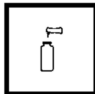
4. 加入一包亚铁试剂粉包到比色瓶中(待测样品), 混合。
