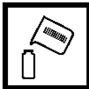
3、将 10ml 试样装入 Cell。注：可以 0.25mg/L 标准试样确认测试结果的精确度。
