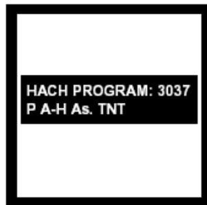
3. 屏幕显示:HACH PROGRAM: 3037 P A-H As. TNT,波长自动调节为890nm。
