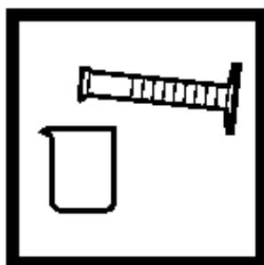
3. 往一个100mL的塑料量筒中装入100mL水，待测。将样品倒入250mL塑料大口杯。
