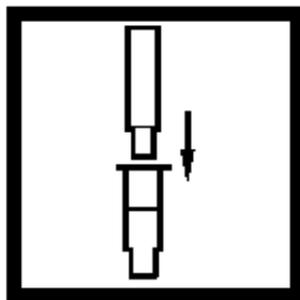
7. 将过滤活塞插入过滤瓶中，压紧，在活塞中心收集至少0.5mL过滤样品。
