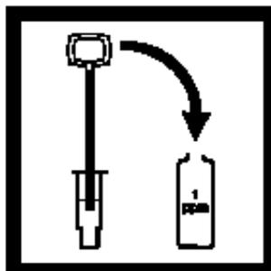
2. 用 WireTrol移液管, 从过滤活塞中移取100  $\mu$  L (0.1mL) 样品提取液到1ppm 稀释安培瓶中, 充分混合, 弃去毛细管。
