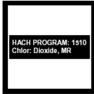
2. 屏幕将显示: HACH PROGRAM: 1510 Chlor: Dioxide, MR, 波长自动调节为 360 nm。
