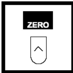
13. 当计时器显示 2:00, 按 ZERO, 屏幕显示: 0  $\mu\text{g/L}$   $\text{CH}_2\text{O}$ 。
