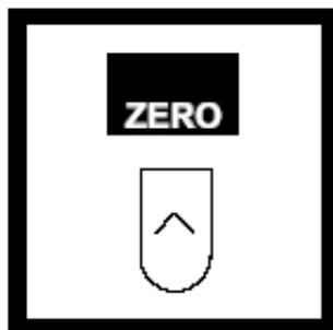
6. 计时器鸣叫时，按ZERO。屏幕显示： $0 \mu\text{g/L Cl}_2$
