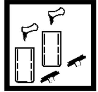
12. 计时器鸣叫后, 各加入一包 BoroTrace #3 试剂粉包到每个比色瓶。盖好盖子并摇晃使粉末溶解。
