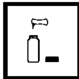
3. 加入一包TPH Stabilizing Agent 试剂粉包到一个空的样品瓶中。在瓶上标记上样品及稀释的情况。
