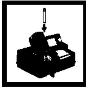
10. 将待测样品放入管适配器, 关上遮光盖。屏幕将显示铜的含量, 单位为g/L。
