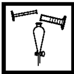
6. 加入 20 mL 50% 的氢氧化钠溶液和 0.1g氰化钾到漏斗。盖好盖子，强烈振荡15秒。
