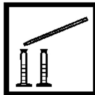
4. 选择消化样品的适当的分析体积, 分别移取分析体积分量的样品和空白到相应的25mL混合量筒中。
