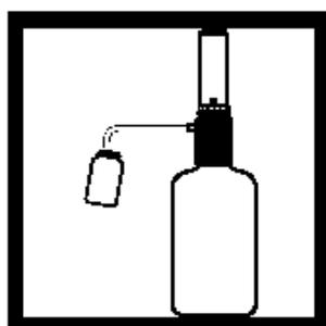
6.用自动分配器或 TenSette吸量管加入 1.0mL浓硫酸到混合瓶中。
