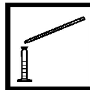
8. 按照测量所需用量的滤液, 将它从50mL量筒中移取到另一个25mL量筒中。
