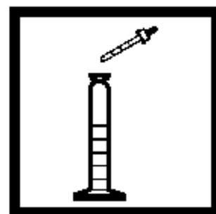
4. 用1.0mL的测量点滴器加入1.0 mL钙镁指示剂溶液，盖上盖子，倒转多次混合。
