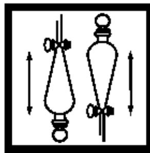
11. 倒转漏斗，不时通通气。适量摇晃漏斗并通气。然后剧烈地摇晃两个漏斗30秒（必要时通气）。
