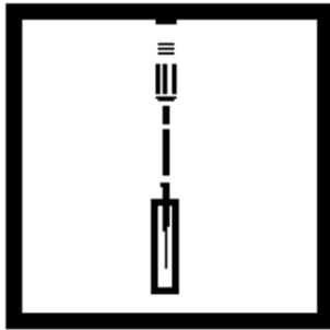
21. 用换上干净吸头的TenSette 移液管量取0.1 mL的0.1 N的盐酸到装样品提取物的玻璃管中。立即按START TIMER启动计时器。
