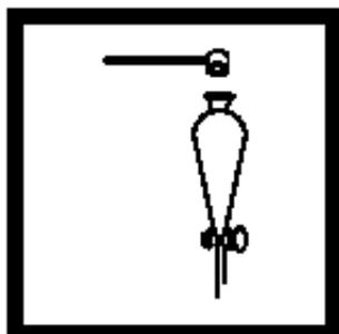
9. 加入 2勺 1.0g 量的氰化钾到漏斗中，盖好盖子。强烈摇晃直到氰化钾全部溶解（大约15秒）。
