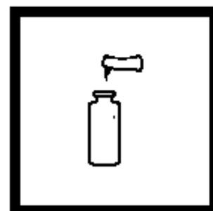
4. 加入一包 SulfaVer 4 试剂粉包到比色瓶中, (待测样品), 混合。
