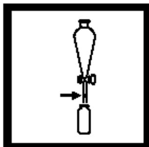
10. 在漏斗的出液管中塞入豌豆大小的棉花，慢慢将下层氯仿液放出到一个干的25mL的比色瓶中，盖上比色瓶。
