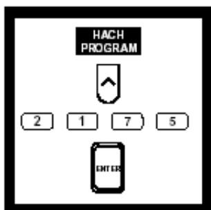
1. 在 HACH PROGRAM 下，选择铁的 FerroZine 程序编号 2175，按 ENTER。
