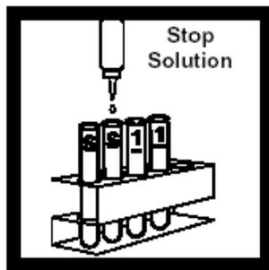
3. 让每管刚好反应2.5分钟，然后滴加5滴免疫停止溶液到每个管中。
