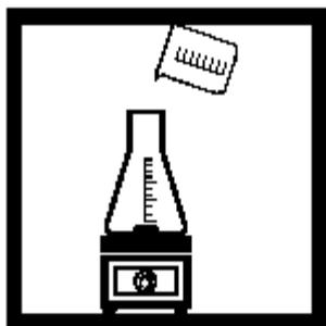
1. 把一升样品放入 2000ml 长颈瓶，加入磁搅拌器，放置在磁动加热器上。
