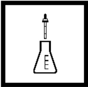
5. 分别加入 0.5 mL 缓冲溶液，pH 2.5，到每个瓶中，混合。
