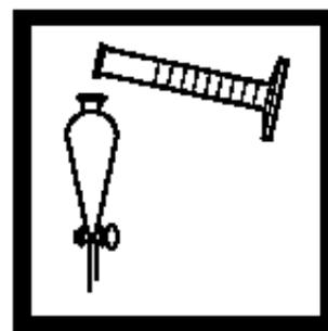
8. 加入 30 mL 的 DithiVer 溶液到 500mL 分液漏斗。盖好盖子，倒转，打开活塞通气，关上活塞，摇晃漏斗一到两次，再通气。按 START TIMER。关上活塞，并在 1 分钟的反应计时期间中强烈摇晃漏斗。
