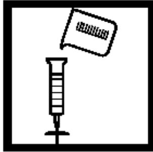
2. 用样品冲洗注射器，并装入样品到33cc刻度线。
