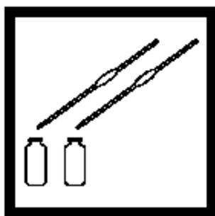
5. 分别量取 2.0 mL 硫氰酸汞溶液到每个比色瓶中，混合。
