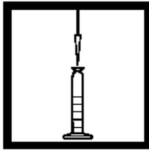
10. 用TenSette移液管从安培瓶中移取1.0 mL指示剂溶液到量筒中。混合试剂，1分钟内进行步骤11。
