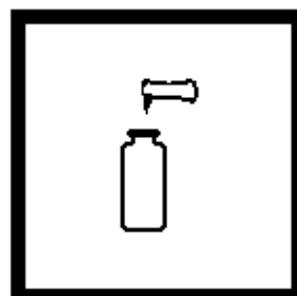
4. 加入一包 10mL 样品用的FerroVer铁试剂粉包到比色瓶中（待测样品），混合。
