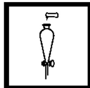
4. 加入一包镍1试剂粉包到漏斗中，盖好盖子，摇晃混合。
