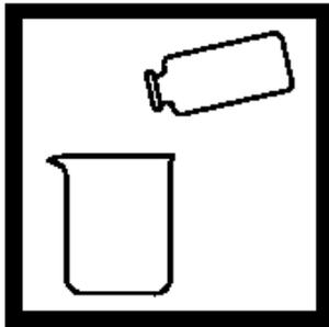
9. 倒出约15 mL样品到一个50mL大口杯中, 1英寸比色瓶中剩余10mL。此为待测样品。
