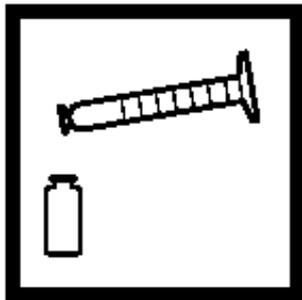
9. 反应期间，从量筒中倒出溶液到比色瓶（待测试样）。
