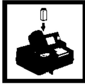
10. 计时器鸣叫后7分钟内, 将待测样品放入比色瓶槽, 关上遮光盖。屏幕将显示钾的含量, 单位为mg/L。
