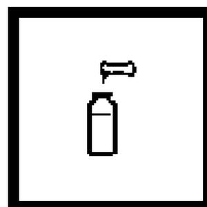
4. 往比色瓶中加入一包CuVer 1 铜试剂粉包（待测样品），混合。
