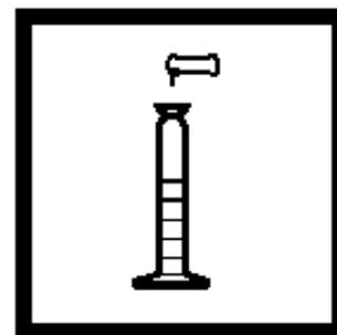
4. 加入一包钼 1 试剂粉包到量筒中，盖上盖子，然后摇晃量筒使试剂溶解。此为待测试样。
