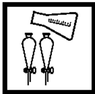
11. 将两个瓶里的内容物分别转移到两个250mL的分液漏斗中，标记其中一个为“空白试样”，另一个为“样品”。
