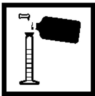
5. 加入30 mL 氯仿到50mL混合量筒中，加入一包DithiVer Metals试剂粉包。盖好量筒，倒转多次混合（此为DithiVer 溶液）。
