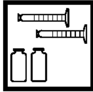
7. 分别将溶液转移到两个干的比色瓶中，分别标记为“空白”和“样品”。5 分钟颜色生成期间比色瓶置黑暗处。
