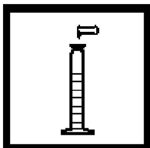
5. 加入一包 AluVer3 铝试剂粉包，按START TIMER，反复倒转1分钟使粉末溶解。
