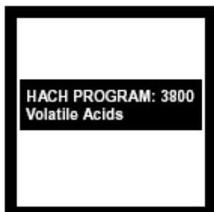
2. 屏幕显示：HACH PROGRAM：3800 Volatile Acids，且波长自动调节为495 nm。
