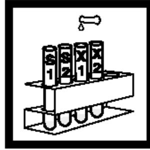
3. 打开一包TPH 缓冲粉剂，将其倒入“标准1”酶联管中，对其它酶联管采取相同操作。
