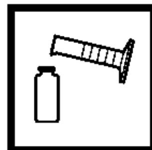
4. 用量筒量取 10 mL 样品到另一个比色瓶中 (待测样品)。
