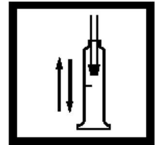
16. 在砷吸收溶液中上下移动气体 bubbler 来清洗。
