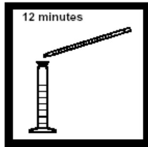
10. 当计时器显示 12:00 时, 加入 2.5 ml 低量程甲醛的 Developing 溶液到空白试样中, 盖上量筒。混合。
