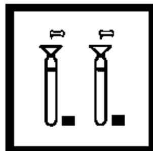
4. 分别加入一包氨水杨酸盐试剂粉包(用于5mL样品)到每个瓶中。
