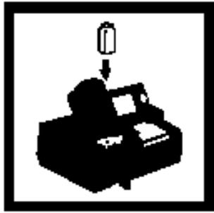
9. 计时器鸣叫后10分钟内，将待测试样放入比色瓶槽，盖上遮光盖。屏幕显示钡的含量，单位是mg/L。
