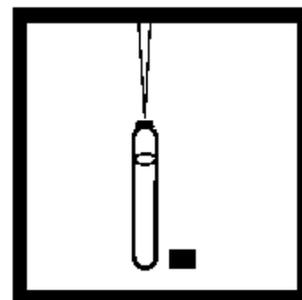
4. 用 TenSette 移液管加入5.0mL样品到另一个高含量反应磷的TNT瓶中（空白样品），盖好盖子，混合。
