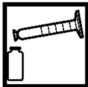
5. 往一个干净的配套的比色瓶装入待测样品至25mL刻度线。保留余下的25mL待测样品用于步骤8。
