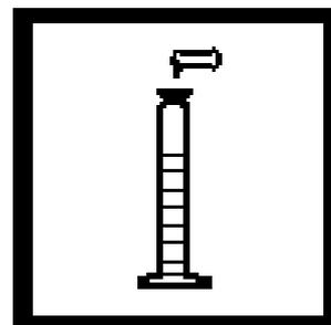
4. 加入一包抗坏血酸粉末，塞好塞子，倒转多次使粉末溶解。
