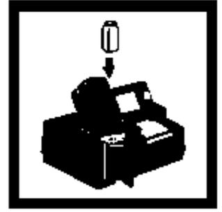
12. 将待测样品放入比色瓶槽,关上遮光盖。屏幕将显示Pt-Co的单位数。
