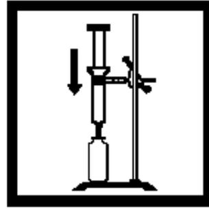
11. 当洗提液开始从萃取器中滴出时, 插入活塞, 缓慢加压, 使剩余的洗提液流过萃取器。紧紧压缩吸收垫。比色瓶中的溶液体积应为 25mL。
