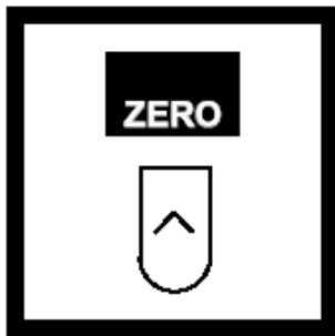
13. 按 ZERO, 屏幕显示: 0.00 mg/L PO<sub>4</sub><sup>3-</sup>
