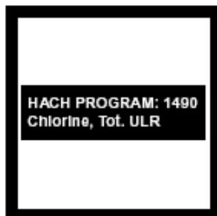
2. 屏幕显示：HACH PROGRAM: 1490 Chlorine, Tot. ULR，波长自动调节为515nm。注：至少每天测定一次指示剂/缓冲试剂溶液的试剂空白。如果样品颜色或浊度波动，对每种样品测定试剂空白。
