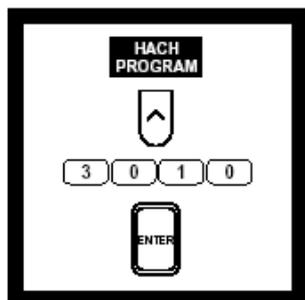
1. 在HACH PROGRAM下, 选择反应磷的氨基酸法程序编号3010, ENTER。
