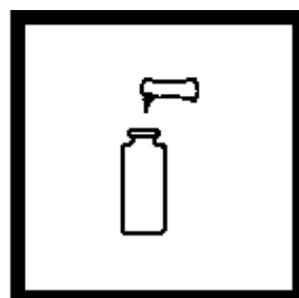
4. 加入一包TPTZ铁试剂粉包到比色瓶中（待测样品），盖上盖子，摇晃30秒，取走盖子。
