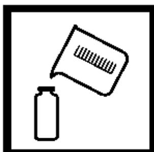
6、另倒 10ml 试样 (空白试样) 至另一个 Cell。注：若试样浊度高，加一颗 Acid Reagent 粉末药包到空白试样，以确保溶入 ChromaVer3 酸性溶入空白试样中。
