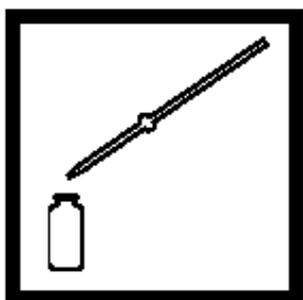
5. 取出0.5mL过滤液或上清液到另一个25mL的干燥比色瓶中(待测试样)。注：为了验证准确度，使用0.5mL的500mg/L的挥发性酸标准溶液代替样品溶液。
