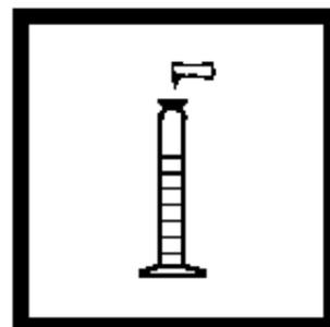
4. 加入一包NitraVer 6试剂粉包到量筒中，盖好盖子。
