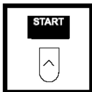
11. 按START, 仪器在220和275 nm波长下读数。完成后, 屏幕将显示样品中的硝酸盐-氮含量。
