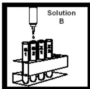
2. 开始2.5分钟反应计时，立即加入5滴溶液B到每个管。混合。重新盖上瓶盖。注：某些或所有管中的溶液将变蓝。
