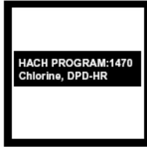
2. 屏幕将出现 HACH PROGRAM : 1470 Chlorine, DPD-HR. 且自动调整波长至 530nm。
