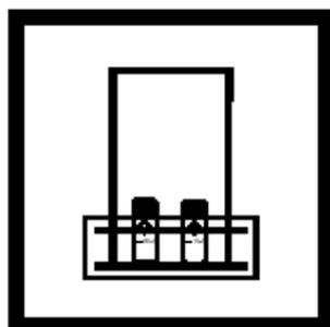
16. 取新的冷自来水，更换冷却水，将装有“样品”和“空白”的比色瓶的篮子放入冷水浴中。
