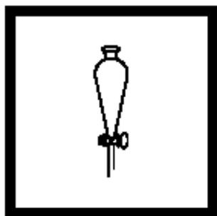
8. 当计时器鸣叫时，取走塞子并分出下层水层，弃去该水层，放入适当的废物收集器中。
