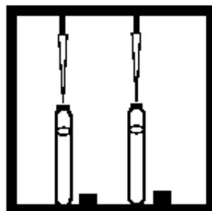
3. 打开两个AmVer稀释试剂高含量瓶的盖子, 加入0.1 mL 不含氨的水到其中一瓶中(空白试样), 加入0.1mL 样品到另一瓶中(待测试样)。
