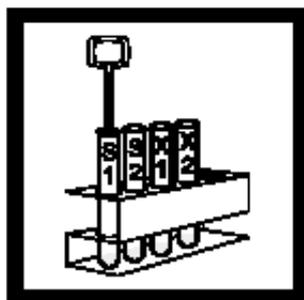
6. 用WireTrol Pipet, 加入50  $\mu$ L TPH Standard 到标记为标准1，标准2的TPH Enzyme Conjugate tubes中，充分混合。
