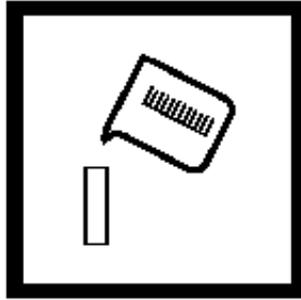
6. 用不含有机物的水清洗一个干净的 1-cm 石英比色皿几次。往比色皿中装入不含有机物的水（试剂空白），擦净比色皿瓶壁。
