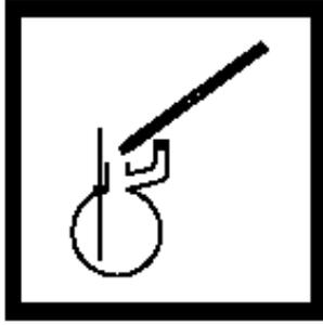
9. 加入 1 mL 氯化砷溶液到蒸馏瓶中。
