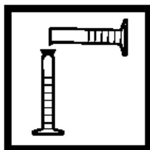
5. 用 50-mL量筒加入 50 mL 样品到步骤4中的50-mL混合量筒中，盖好盖子。倒转混合一分钟。
