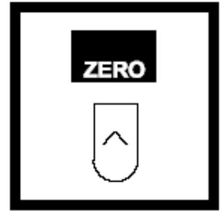
12. 按ZERO，屏幕显示： $-0.01 \text{ mg/L NH}_2\text{Cl—N}$ 。
