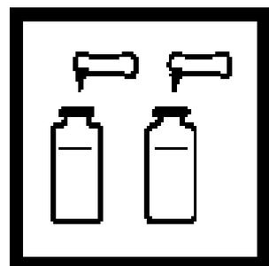
6. 各加入一包卟啉2试剂粉包到每个比色瓶中，混合使粉末溶解。
