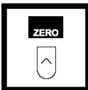
6. 按ZERO，从780nm开始，仪器将以5nm的间隔为空白建立100%透光值，直到380nm。屏幕显示：
