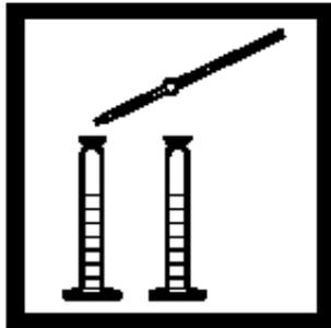
6. 精确加入 1.00 mL 二氧化氯试剂 2 到每个量筒中，盖上盖子，反转多次混合。
