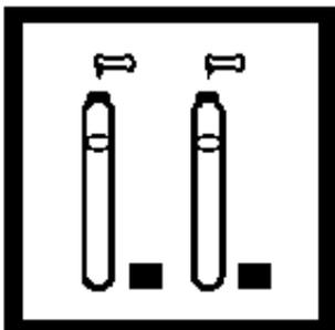
6. 各加入一包酸试剂粉包到每个管中。轻轻混合。
