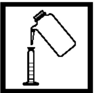
18. 加入去离子水到量筒，使体积刚好为25ml。盖好盖子，混合。标记量筒为“试剂空白”。
