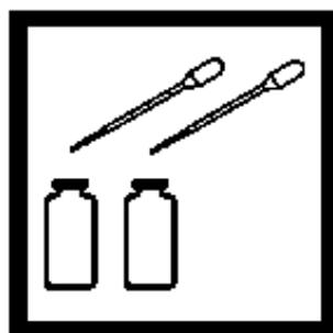
6. 加入0.5 mL的0.3%的PAN 指示剂溶液到每个管中。盖好每个管。倒转多次混合。
