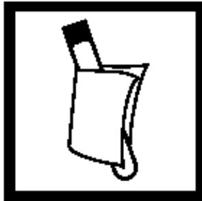
14. 当计时器鸣叫时，用毛巾清洁瓶外侧，将空白试样放入样品瓶槽，关上遮光盖。
