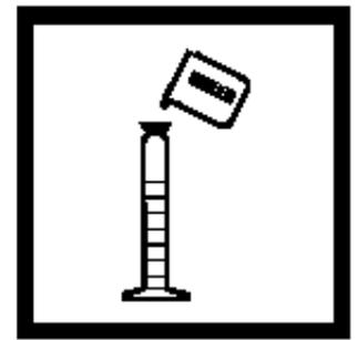
4. 在另一个50mL混合量筒中精确量取25mL不含甲醛的水（空白试样）。
