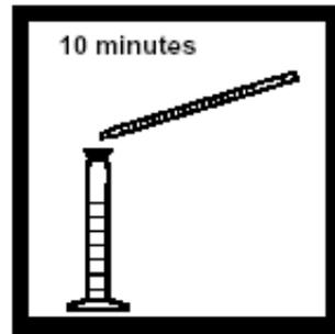
11. 当计时器显示 10:00 时, 加入 2.5 ml 低量程甲醛的 Developing 溶液到待测样品中, 盖上量筒, 混合。
