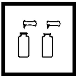
9. 加入一包偏亚硫酸氢钠试剂粉包到每个管中，混合使粉末溶解。
