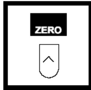
11. 按 ZERO, 从700nm开始到400nm, 仪器将以10nm的间隔读出透光度。
