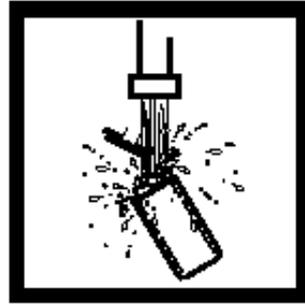
3. 用待测的水冲洗一个塑料比色瓶和盖子三次, 不要让盖子的下部碰到管的表面, 以防污染。
