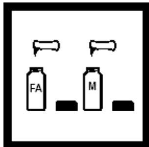
6. 迅速加入一包一氯胺试剂粉包到标记为“游离氨”的比色瓶中,加入另一包到标记为“一氯胺”的比色瓶中。盖上盖子,摇晃瓶子使粉末溶解。
