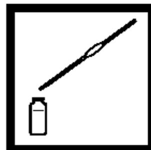
4. 量取 15.00 mL 稀释过的样品电解质溶液到一个干净的比色管中(待测试样)。
