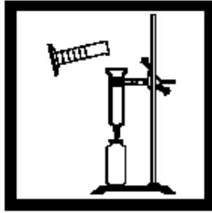
10. 将 25-mL 的比色瓶放在萃取器下, 用 25-mL 塑料量筒加入 25mL pPb-3 洗提液到萃取器中。
