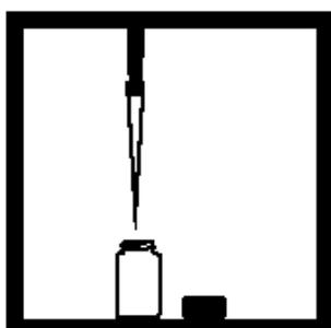
5. 用TenSette移液管或吸量管吸取 9.0mL均匀的样品到一个空的玻璃混合瓶中。如样品COD超过1000 mg/L,按表1所示稀释样品。
