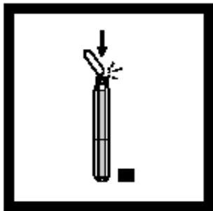
9. 将未开封的安培瓶放入酸消化瓶中，当安培瓶的刻度与酸消化瓶顶部平齐时，折断安培瓶的顶部，让其落入酸消化瓶。注：将安培瓶插入后，不要反转或倾斜组合瓶，以防止指示剂与酸消化瓶中的试剂混合。
