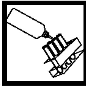
10. 用洗液彻底清洗每个管4次，倒空每个管，振荡，使每次洗完后都不残留洗液。
