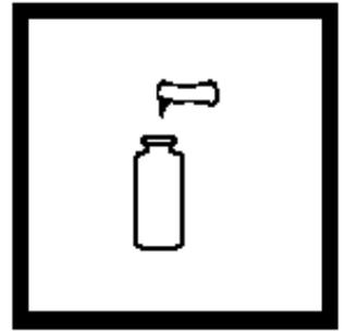
4. 加入一包 NitriVer 2亚硝酸盐试剂粉包, 盖上盖子, 摇晃使溶解(待测试样)。
