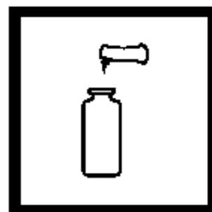
4. 加入一包 BariVer 4 钡试剂粉包到比色瓶（待测试样）中，混合。
