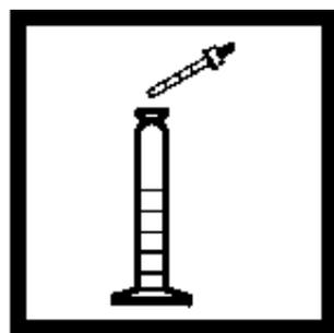
5. 用1.0mL的测量点滴器加入1.0 mL碱溶液，盖上盖子，倒转多次混合。
