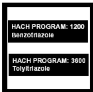
2. 屏幕显示：HACH PROGRAM: 1200 Benzotriazole 或 HACH PROGRAM: 3600 Tolyltriazole，波长自动调节为425 nm。
