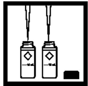
8. 用 TenSette 移液管分别加入 3 mL THM Plus试剂 2 到每个管中。
