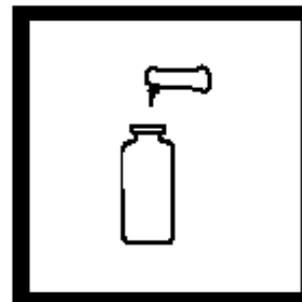
6. 加入一包 DPD 自由氯试剂粉包到待测样品的比色瓶中。旋转比色瓶20秒混合。等待30秒使不溶解粉末沉淀。立即进行步骤8。
