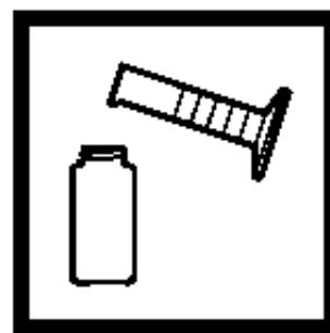
4. 将10.0 mL样品倒入另一个比色瓶中（待测样品）。
