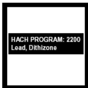
2. 屏幕显示：HACH PROGRAM: 2200 Lead, Dithizone，波长自动调节为515 nm。
