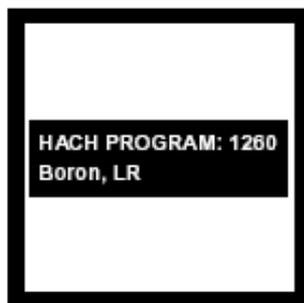
2.屏幕显示: HACH PROGRAM: 1260 Boron, LR, 波长自动调节为 410nm。
