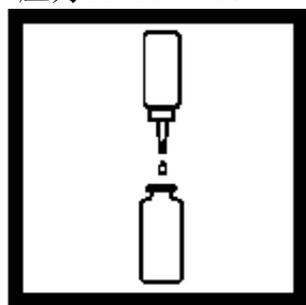
7. 加入一滴1 M的EDTA溶液到比色瓶中（空白试样），混合。
