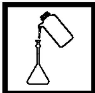
6. 倒入去离子水 至100mL刻度线，盖上盖子，倒转多次使溶解。
