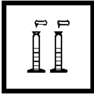
9. 当计时器鸣叫时, 分别加入一包偏亚硫酸氢钠试剂粉包到每个量筒中, 盖好盖子, 倒转几次混合。
