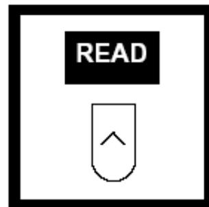
12. 按 READ，仪器将读取560 nm和 620 nm下样品的浓度值。读取完毕，屏幕将显示镍的含量，单位为 mg/L。
