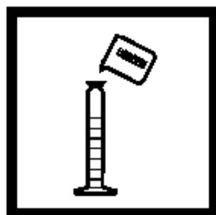
3. 将 100 mL样品倒入 100mL 混合量筒中。
