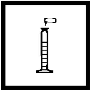
5. 加入一包脱氯试剂粉包到其中一个量筒中，盖上盖子，倒转多次直到粉末溶解。此为空白试样，另一量筒中的溶液为待测样品。
