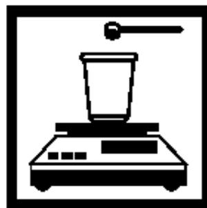
3. 根据所需的Cr<sup>6+</sup>水平, 精确称取所需的样品。将土样放入whirl-pak bag或样品杯中。
