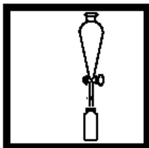
9. 将上层的苯溶液倒入一个干净的25mL比色瓶中(待测样品)。
