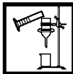
4. 倒入至少50mL不含有机物的水到漏斗中，预清洗过滤装置。弃去过滤后的水。
