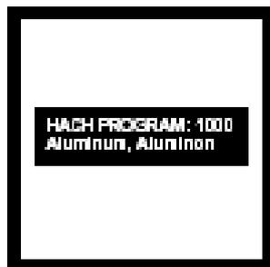
2. 屏幕显示：HACH PROGRAM: 1000 Aluminum, Aluminon, 波长自动调节为535 nm。
