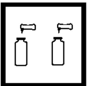
6. 分别加入一包Q.A.C. 试剂2粉包到每个管中,旋转(不要摇晃)比色瓶使试剂溶解。
