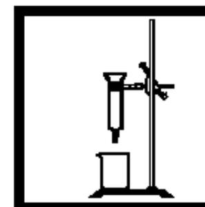
7. 将一个新的快速柱式萃取器放在环架上夹好。在萃取器下放置一个 150-mL 的塑料大口杯。
