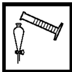
3. 用一个干净的500-mL量筒中量取样品至300-mL刻度线。将样品倒入一个干净的500-mL分液漏斗中。
