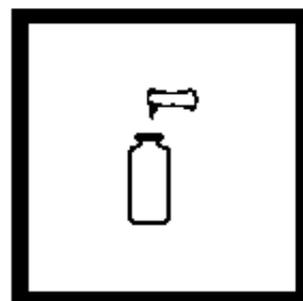
4. 加入一包三唑试剂粉包，混合使粉末完全溶解。
