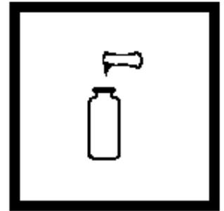
4. 加入一包铬1号试剂粉包（待测样品）。混合。
