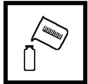
8. 往1英寸正方形比色瓶中装入调节过 pH 的过滤样品（样品），弃去多余液体。
