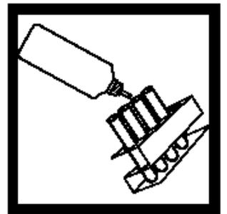
4. 用洗液彻底清洗每个管4次，将管倒空，内容物放适当的废物缸。充分摇晃确保每次洗完后没有洗液残留。
