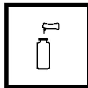
4. 加入一包NitraVer 5硝酸盐试剂粉包(待测试样), 盖上盖子。
