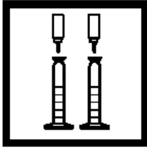
9. 分别加入3滴 Polyvinyl Alcohol Dispersing 试剂到量筒中，盖好盖子，混合。
