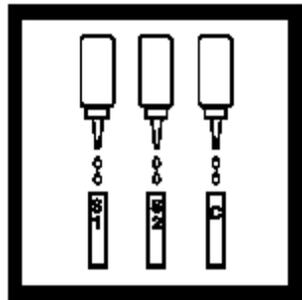
9. 加入2滴Accelerator Solution到各反应皿，加盖摇匀。
