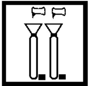
8、待 3 分钟过后，再打开二比色管盖子，再各加入 1 颗 #26720-49 药丸，再旋紧盖子，摇晃 15 秒后，按下 Start Timer 功能键，进行 2 分钟计时。PS. 此时溶液应呈黄色。
