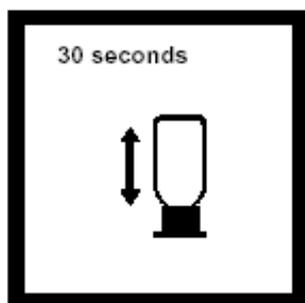
6. 不反转安培瓶，立即将充满样品的安培盖稳放在安培瓶的尖端上。摇晃瓶约30秒。
