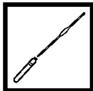
4. 量取 3.0 mL 电解质试样和 2.0 mL 去离子水到16mm的管中（待测样品）。
