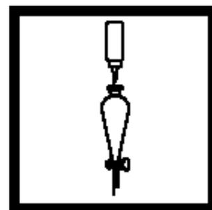
8. 继续逐滴加5.0 N氢氧化钠标准溶液，每加几滴就摇晃漏斗，直到摇晃后溶液的颜色从蓝绿色变成橙色。然后多加5滴 5.0 N的氢氧化钠溶液。
