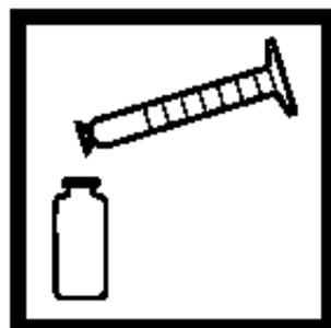
7. 当计时器鸣叫时，小心将10mL样品倒入一个干净的比色瓶中。注意不要转移镉的微粒。
