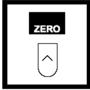
6. 按ZERO，从780nm开始，仪器将以5nm的间隔为空白建立100%透光值，直到380nm。屏幕显示：0.0 Gardner Units。
