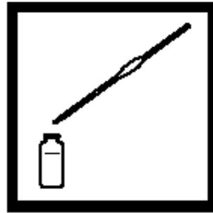
3. 量取25 mL样品到一个比色瓶中, 此为待测样品。注: 对于浑浊样品, 参阅步骤后之“干扰”的预处理指示。注: 过度的搅动样品会损失硫化物, 用移液管量取减少硫化物的损失。
