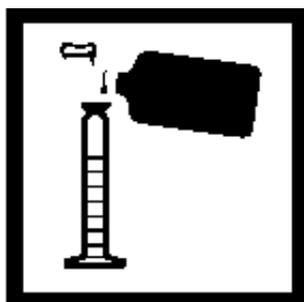
6. 往 50 mL混合量筒中加入 50mL氯仿。加入一包DithiVer金属试剂粉包。盖上盖子，反复倒转混合。往另一个量筒中倒入30mL双硫脲溶液。
