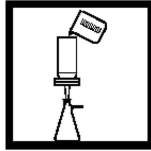
3. 用大约50mL的原始样品溶液冲洗过滤器，弃去冲洗液。
