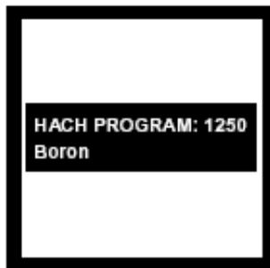
2. 屏幕显示：HACH PROGRAM: 1250 Boron，波长自动调节为605 nm。
