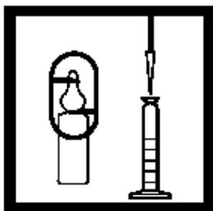
6. 打开一安培瓶用于极低含量氯的DPD 指示剂溶液。用TenSette移液管从安培瓶中移取1.0 mL指示剂溶液到量筒中。混合试剂，1分钟内进行步骤7。
