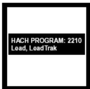
2. 屏幕显示：HACH PROGRAM: 2210 Lead, LeadTrak，波长自动调节为 477nm。
