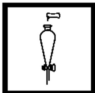
6. 当计时器鸣叫时，加入一包镍2试剂粉包到漏斗中，盖好盖子，摇晃混合。
