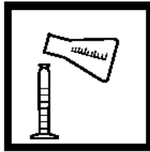
11. 不要过分搅动，小心往量筒中装入样品至50mL刻度线，盖上盖子。轻轻反转两次混合（待测试样）。
