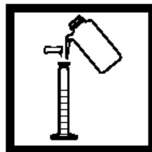
4. 制备提取溶液: 加入一包六价铬提取剂粉包到 50-mL量筒中, 加入 40mL去离子水, 盖上盖子, 混合使粉末溶解。
