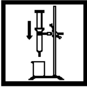
9. 液体流完后, 用活塞紧压萃取器中的吸收垫, 弃去大口杯中的溶液, 从萃取器中慢慢取出活塞。
