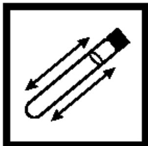
7. 等到泡沫（冒泡）停止。盖上盖子并摇晃管，使所有的粉末溶解。
