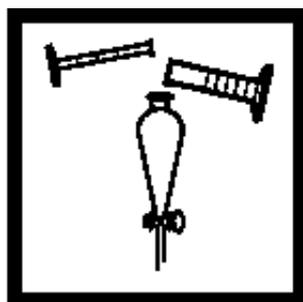
7. 加入30 mL双硫脲到分液漏斗中，盖好盖子，倒转。打开活塞通气。关上活塞，并加入5 mL的5.0 N氢氧化钠标准溶液，盖上盖子，倒转。打开活塞通气。关上活塞，摇晃漏斗一到两次，通气。
