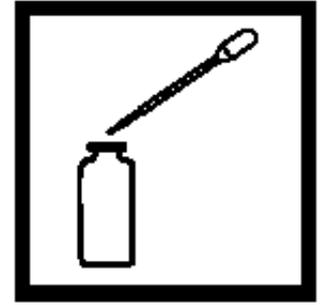
12. 用 1-mL 塑料点滴器, 加入 1.0 mL pPb-4 中和溶液到比色瓶中, 充分混合, 立即进行步骤 13。
