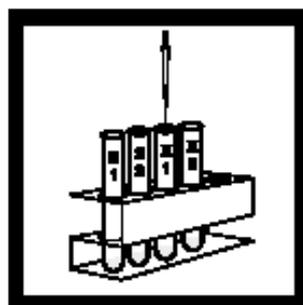
3. 用TenSette Pipet, 加入2.0 mL待测试样到标记为样品1和样品2的TPH Enzyme Conjugate tubes 中。
