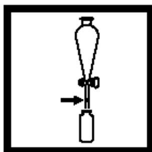
11. 当计时器鸣叫时，等待溶液分层。在漏斗的出液管中塞入豌豆大小的棉花，分出氯仿层（下层）到一个比色瓶中（待测样品），盖好盖子。
