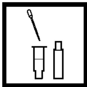
6. 用移液管移取提取瓶中上层的 1.0-1.5 mL溶液到过滤瓶中。
