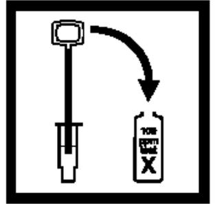
8. 用WireTrol移液管从过滤活塞中移取0.1mL样品提取液加入到100ppm稀释安培瓶中，充分混合。
