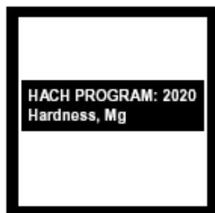
2. 屏幕显示：HACH PROGRAM：2020 Hardness, Mg，波长自动调节为522nm。
