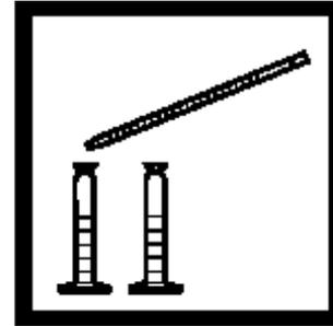
7、加入 1 ml Nessler Reagent 药液于二量筒内,加上塞子,激烈摇晃之。(如果氨氮存在,会有黄色呈色出现)。
