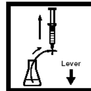
15. 通过管道吸入至少10 cc洗提液到注射器中，然后吸入少量空气，超过25cc刻度线。
