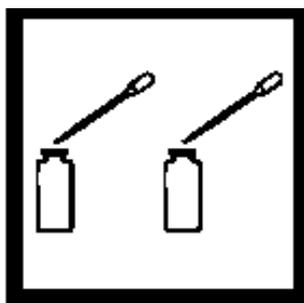
6. 往每个管中分别加入1.0 mL 0.3% PAN指示剂溶液,倒转几次,混合。
