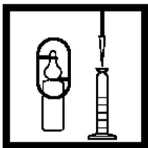
5. 计时器鸣叫后，打开一安培瓶用于极低含量氯的ULR 氯缓冲溶液，用TenSette移液管从安培瓶中移取1.0 mL缓冲溶液到一个干净的混合量筒中。
