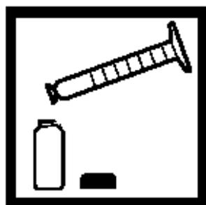
4. 将样品倒入有标记的样品瓶中直到瓶满。盖上盖子。混合直到TPH Stabilizing Agent 溶解。立即进行第2阶段。
