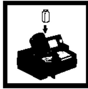
11. 将待测试样放入比色瓶槽，关上遮光盖，屏幕将显示氨氮的含量，单位为mg/L。
