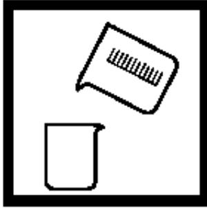
1. 在400 mL大口杯中收集200-250 mL样品。看需要，用1.0N的HCl或1.0N的NaOH调节pH到7.6。
