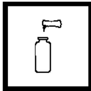
6. 加入一包DPD余氯粉包到比色瓶中（待测试样），旋转混合20秒，立即进行步骤7。
