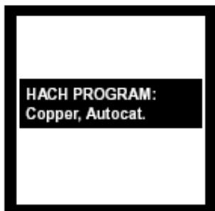
2. 屏幕显示：USER PROGRAM:Copper, Autocat. 波长自动调节为810 nm。
