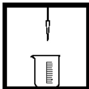
3. 用TenSette移液管，加入1.0 mL Blanking试剂到大口杯中，混合。
