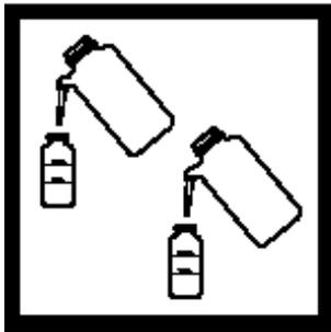
5. 加入试剂后 1min 之内，将两个试样槽以去离子水加至 25ml。盖上盖子翻转两次。
