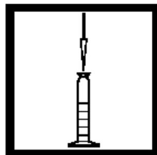
8. 用TenSette移液管从安培瓶中移取1.0 mL缓冲溶液到一个干净的50mL的混合量筒中。注：安培瓶中的溶液应不少于1.0mL，可方便移取，弃去安培瓶中多余的试剂。
