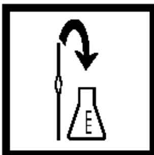
5. 准确量取2.0 mL 去离子水到125mL的塑料锥形瓶中（空白试样）。
