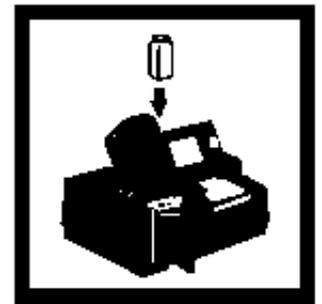
12. 在计时器显示 2:00 前, 将空白试样倒入比色瓶中, 将比色瓶放入管槽中, 关上遮光盖。
