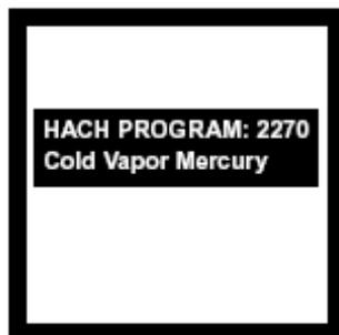
26. 屏幕将出现 HACH PROGRAM: 2270 Cold Vapor Mercury 自动调整波长至 412nm。
