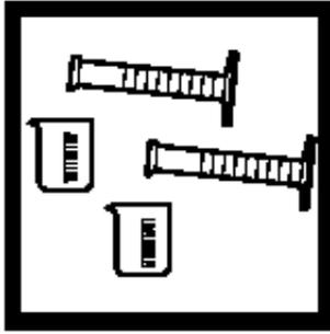
1. 如果样品不浑浊，省略步骤2-5。往两个大口杯中各倒入100ml样品，调节其中一个杯中的溶液至pH为7.6，另一个不作调整。
