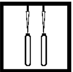
7. 用TenSette 移液管分别加入3.0 mL 不含有机物的水到试剂空白的瓶中，加入3.0mL待测试样到样品瓶中，混合。
