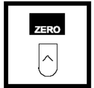
16. 按 ZERO, 屏幕将显示:  $-2 \mu\text{g}/\text{L Pb}$ 。注: 按 ZERO 结果显示 -2, 是由于该程序用非零 y-intercept.
