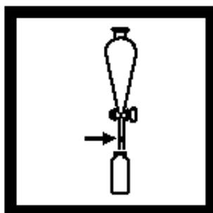
10. 往漏斗的出液管中塞入黄豆大小的棉花，慢慢让下层（氯仿）溶液流出到一个干的25mL的比色瓶中（待测试样）。盖好盖子。
