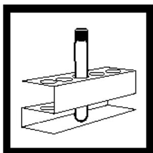
6. 计时器鸣叫后,小心从反应炉中取走瓶子,将其放于试管架冷却至室温。
