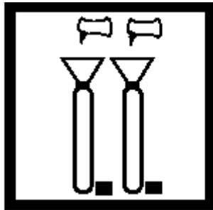
7、打开已冷却的二比色管盖子，再各加入 1 颗 #26719-49 药丸，再旋紧盖子，摇晃 15 秒后，按下 Start Timer 功能键，进行 3 分钟计时。
