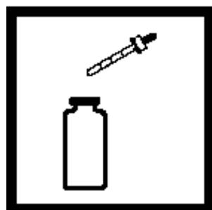
5. 在比色瓶中各加入 0.5 mL HydraVer 2 联氨试剂, 混合。
