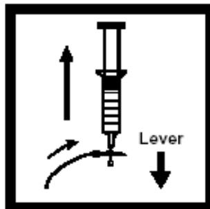
13. 再将阀门转到吸气档(向下)。通过管道吸入约5cc洗提液到注射器中，然后吸入少量空气，超过25cc刻度线。
