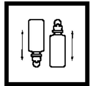
8. 轻轻地倒转待测试样两次, 取走盖子。
