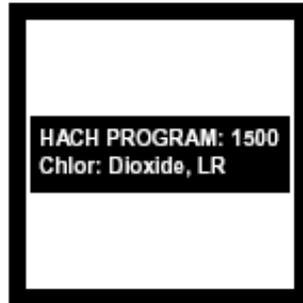
2. 屏幕显示：HACH PROGRAM : 1500 Chlor: Dioxide, LR，波长自动调节为575nm。
