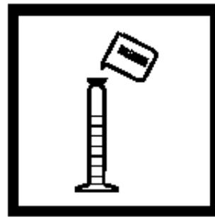
3. 在50mL混合量筒中精确量取25mL样品（待测样品）。
