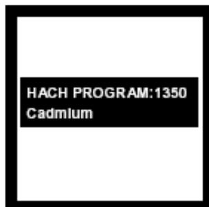
2. 屏幕显示: HACH PROGRAM: 1350 Cadmium, 波长自动调节为515 nm。
