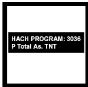
3、屏幕将出现 HACH PROGRAM : 3036 P Total As TNT 且自动调整波长至 890nm。注：玻璃器皿以 1:1 盐酸溶液润湿，再以去离子水冲洗。不能使用磷酸盐制的清洁剂清洗。
