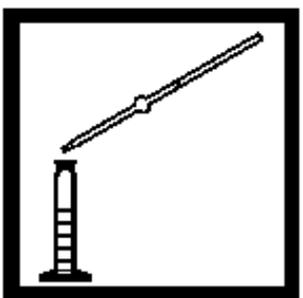
6. 加入0.5 mL钯催化剂样品到其中一个混合量筒中（待测样品），另一个量筒的是空白样品。
