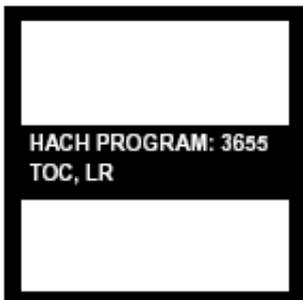
14. 屏幕显示：HACH PROGRAM: 3655 TOC, LR，仪器自动选择多波长设定在598 和430 nm。
