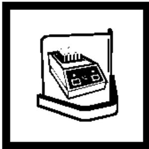
17. 将瓶放入已预热到150° C的COD反应炉中，消化一小时。
