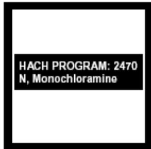
2. 屏幕显示: HACH PROGRAM: 2470 N, Monochloramine, 波长自动调节为655nm。
