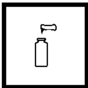
5. 加入一包钾1试剂粉包到样品中(待测样品), 盖好盖子并摇晃使粉末溶解。
