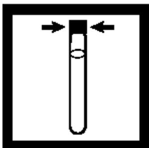
5、盖上试样瓶盖。若有需要，用去离子水冲洗试瓶并用毛巾擦干。
