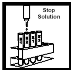
3. 恰好2.5分钟时，加入5滴止停溶液到每个管。重新盖上瓶盖。
