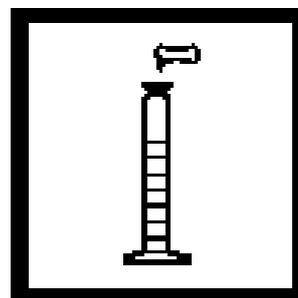
4. 加入20mL样品所需用量的羊毛铬花青R 试剂粉包，塞好塞子，倒转多次使粉末溶解。然后按 START TIMER，并开始30秒计时。
