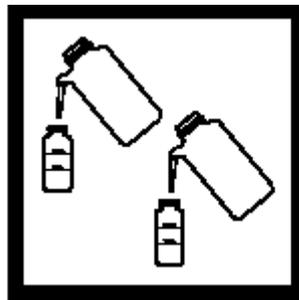
6、反应完三分钟内，向两比色瓶加入去离子水到 25ml 刻度，加盖倒置两次。
