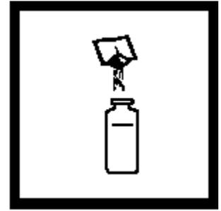
40. 在该水样中加入 HgEX6 铝箔包试剂，充分摇晃溶解。
