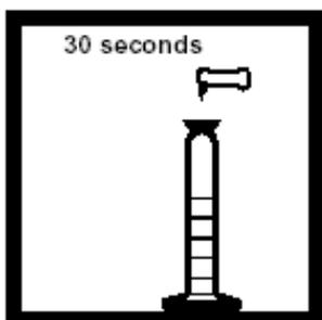
5. 在溶液澄清后，加入一包钾3试剂粉包，盖好盖子。摇晃30秒。
