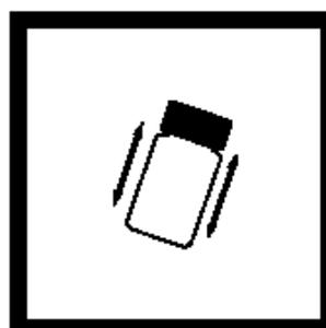
7. 将盖盖严实, 倒转多次, 溶液变热。冷却到室温再继续测试。
