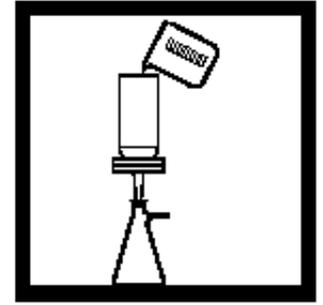
4. 倒出大约50mL原始样品溶液过滤，收集滤液，在过滤瓶上标记“原始液”。
