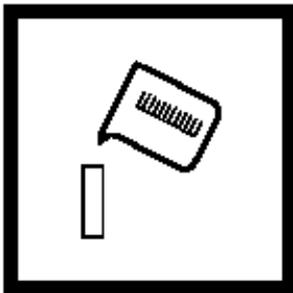
9. 倒出比色皿中的空白溶液，用过滤过的样品清洗比色皿几次。清洗后，往比色皿中装入过滤过的样品。擦管壁除去指纹。
