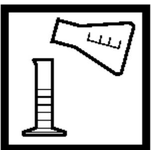
7、将试样倒入 25mL 量筒，调整体积至 25mL。消化步骤至此结束，继续遵照活性磷测浓度。
