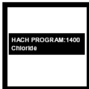
2. 屏幕显示：HACH PROGRAM: 1400 Chloride，波长自动调节为455 nm。
