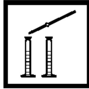
11. 分别移取1.00 mL Nessler试剂到量筒中，盖好盖子，混合。溶液不应浑浊。浑浊会引起错误结果。
