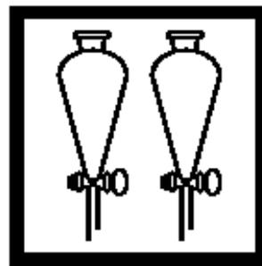
12. 取走盖子，让每个漏斗静置直到氯仿在下层分层。注：如果存在苯酚，氯仿层将呈现黄色到琥珀色。
