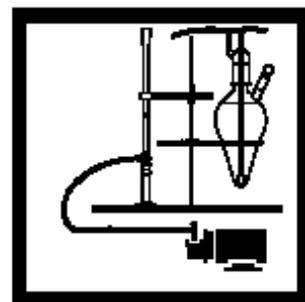
28. 反应时间到后，断开玻璃弯头，保持开着真空泵。
