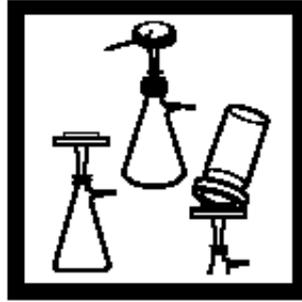
2. 装配过滤装置（0.45微米膜过滤器，过滤架，过滤瓶和吸气瓶）。NCASI 指定0.8微米过滤器。
