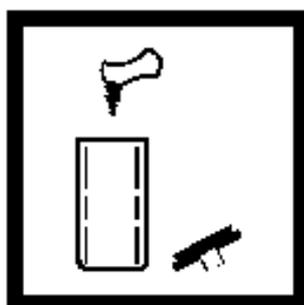
6. 加入一包 BoroTrace #2 试剂粉包到加有样品的比色瓶中。
