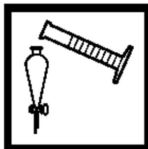
3. 用250mL量筒量取250mL样品, 将样品倒入500mL的分液漏斗中。
