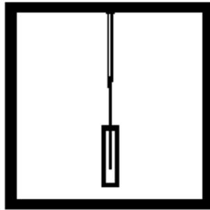
22. 混合样品提取物和盐酸，重复两次以上。不要溅出溶液。重新盖上玻璃管。马上用吸头混合样品提取物和酸。
