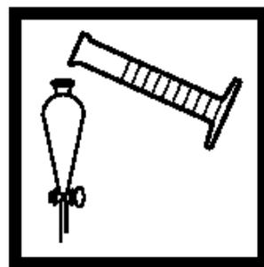
4. 将量取好的去离子水倒入一个500mL分液漏斗中(空白试样)。
