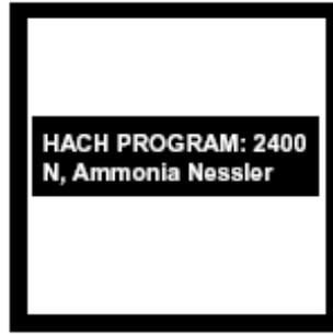
2、屏幕将显示 HACH Program: 2400N, Ammonia Nessler 分析波长自动选择至 425nm。
