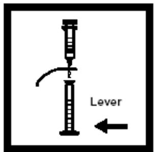
17. 转动阀门的杆，转到抽吸档(向左)，缓慢将洗提液推过LC柱(至少要30秒)。用一个25mL高筒量筒收集洗提液。
