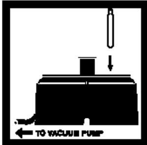
9. 标记每个三价锰COD瓶，取走瓶盖。将瓶放入真空预处理装置 (VPD) 的孔中。
