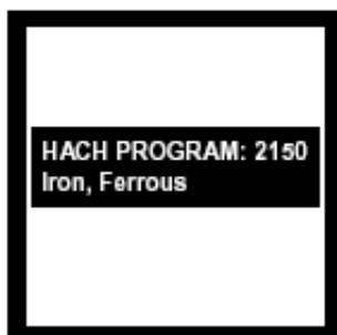
2. 屏幕显示: HACH PROGRAM : 2150 Iron, Ferrous, 波长自动调节为510nm。
