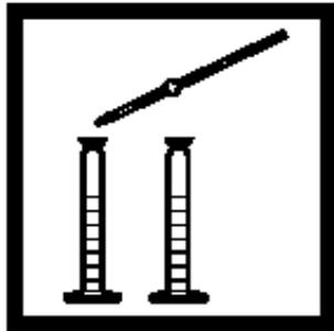
7. 加入 1.0 mL 二氧化氯试剂3到每个量筒。盖上盖子，反转多次混合。
