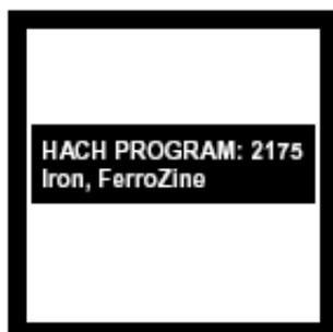
2. 屏幕显示：HACH PROGRAM : 2175 Iron, FerroZine，波长自动调节为 562 nm。
