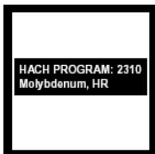
2. 屏幕显示：HACH PROGRAM：2310 Molybdenum, HR，波长自动调节为420nm。
