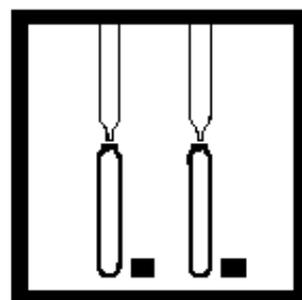
8. 取走两个用于低含量氨氮的AmVer稀释试剂测试管的瓶盖, 用移液管加入2mL离心后的样品到其中一个管中, 加入离心后的空白到另一个管中。作上相应的标记。
