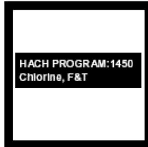
2. 屏幕显示 HACH PROGRAM : 1450 Chlorine, F&T, 波长自动调节为 530nm。
