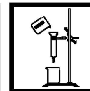
8. 将待测样品缓慢滴加入快速柱式萃取器中，等样品流过萃取器。
