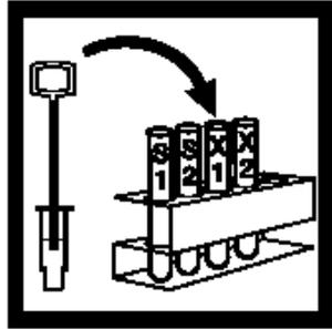
制备10ppm Threshold测量用的样品
