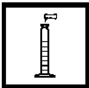
5. 加入20mL样品所需用量的六甲基四胺缓冲试剂粉包，塞好塞子，反复倒转直到粉末溶解。
