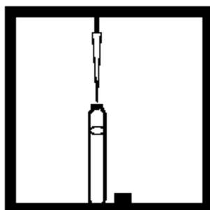
7. 用TenSette移液管,加入2mL1.00N氢氧化钠到瓶中,盖严实,摇晃混合。
