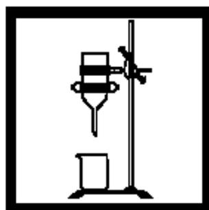
3. 安装过滤装置，包括玻璃过滤漏斗，PTFE支持板，并安装一个70mm的玻璃纤维过滤器。一定要用白色PTFE支持板。放置好滤器，有褶皱的一面向上，将其放在支持板上，并在其下面放一个干净的玻璃大口杯。
