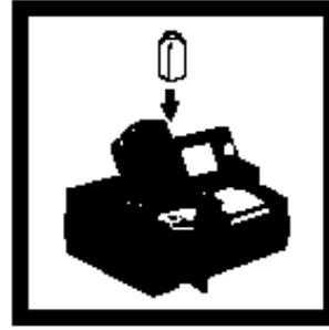
11. 将待测试样放入比色瓶槽，关上遮光盖。屏幕显示苯并三唑或甲苯基三唑的含量，单位是 mg/L。
