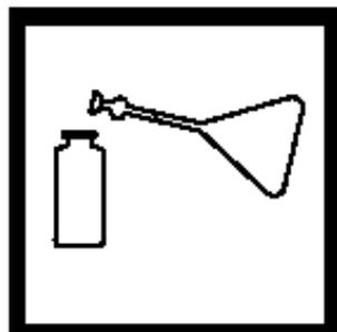
7. 往另一个比色瓶（待测样品）中装入步骤6中的溶液至25mL刻度线。
