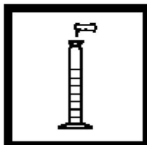
7. 加入一包 Bleaching3试剂粉包到混合量筒剩余的25mL溶液中，塞好塞子，按START TIMER, 强烈摇晃30秒。
