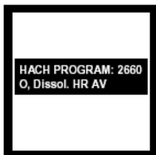
2. 屏幕显示：HACH PROGRAM：2660 O, Dissol. HR AV，波长自动调节为535nm。
