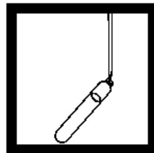
4、将试管斜放 45 度，加入 2ml 试样（测试 0 ~ 15,000 mg/L 时加 0.2mL 试样）。
