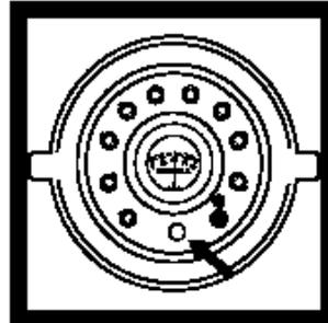
11. 打开真空泵，调节真空调整阀使内标读数为20英寸水。
