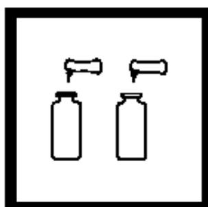
6. 分别加入一包铬1试剂粉包到每个管, 混合使粉末溶解。往每个管上宽松地放上一个空心的聚乙烯塞子。
