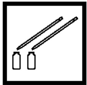
12. 使用移液管，量取2.0 mL的4.5N的氢氧化钠溶液到每个管。旋转混合。
