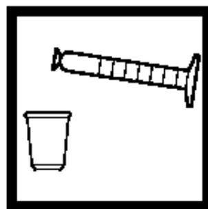
5. 将提取溶液加到whirl-pak bag或样品杯内的土样中, 盖严实。摇晃, 确保土壤完全悬浮在溶液中。
