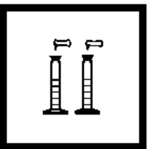
7. 分别加入一包铬1试剂粉末到每个量筒中，盖好盖子。倒转几次混合。
